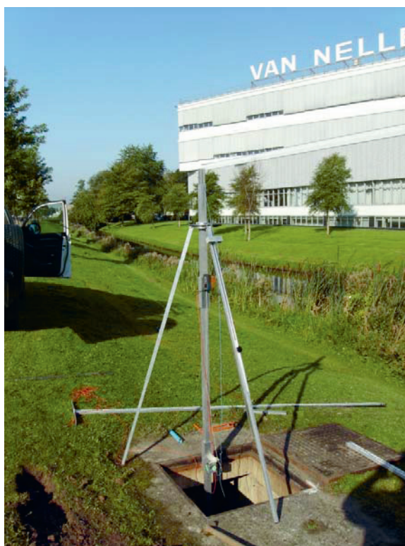
Inmeten van rioolputten zonder af dalen van mensen, i.v.m. risico van gevaarlijke gassen.
