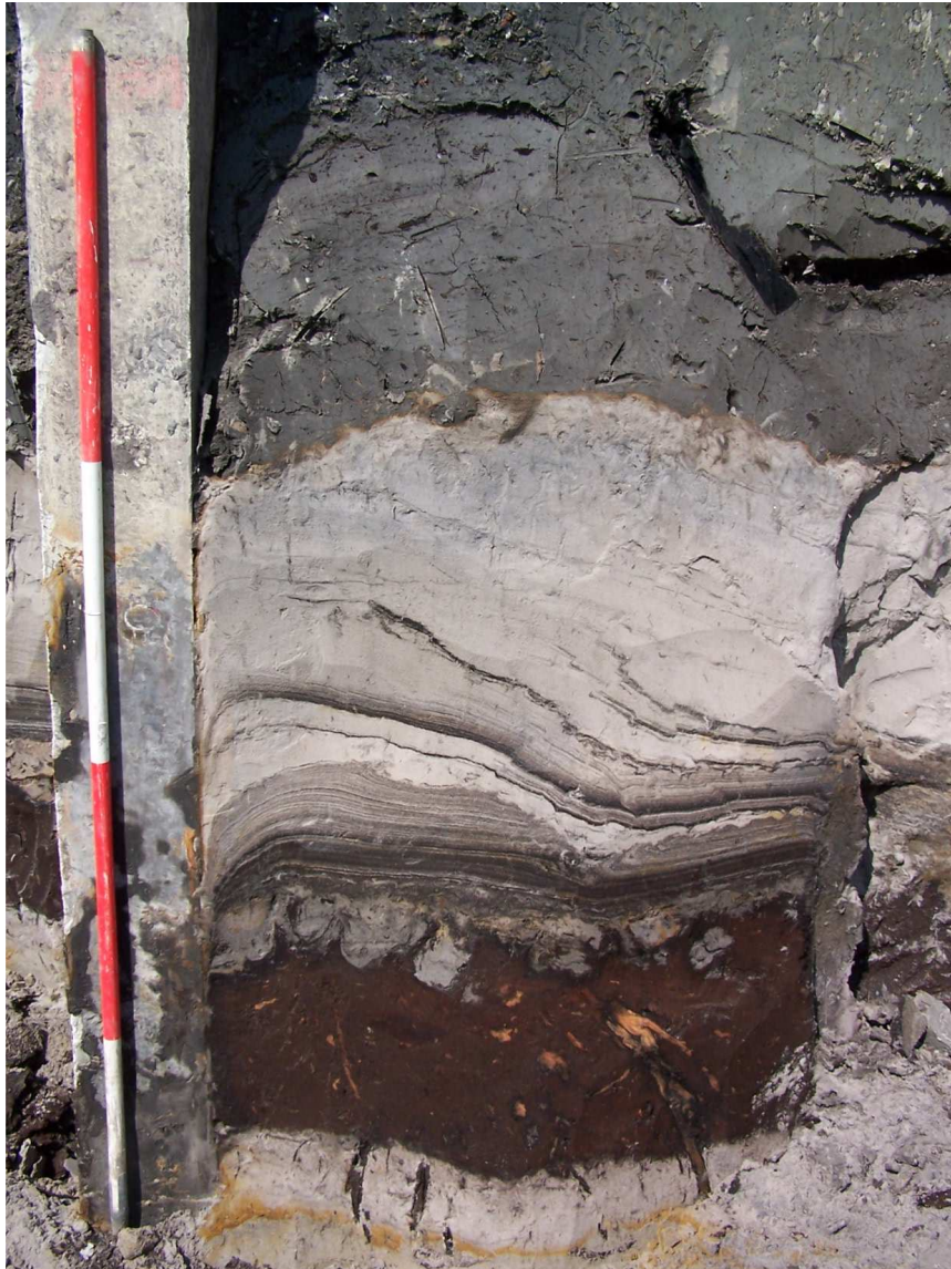
2 B: Heipalen van een gesloopt gebouw in het profiel van een opgravingsput in Voorburg. De paal gaat achtereenvolgens door een kleipakket uit de romeinse haven, een laag zand en een laag neolithisch veen. In de top van het veen zijn afdrukken van koeiepoten te zien. De effecten van het plaatsen van de paal zijn evident in het zand, maar niet in het klei en het veen (Huisman et al. geaccepteerd).
