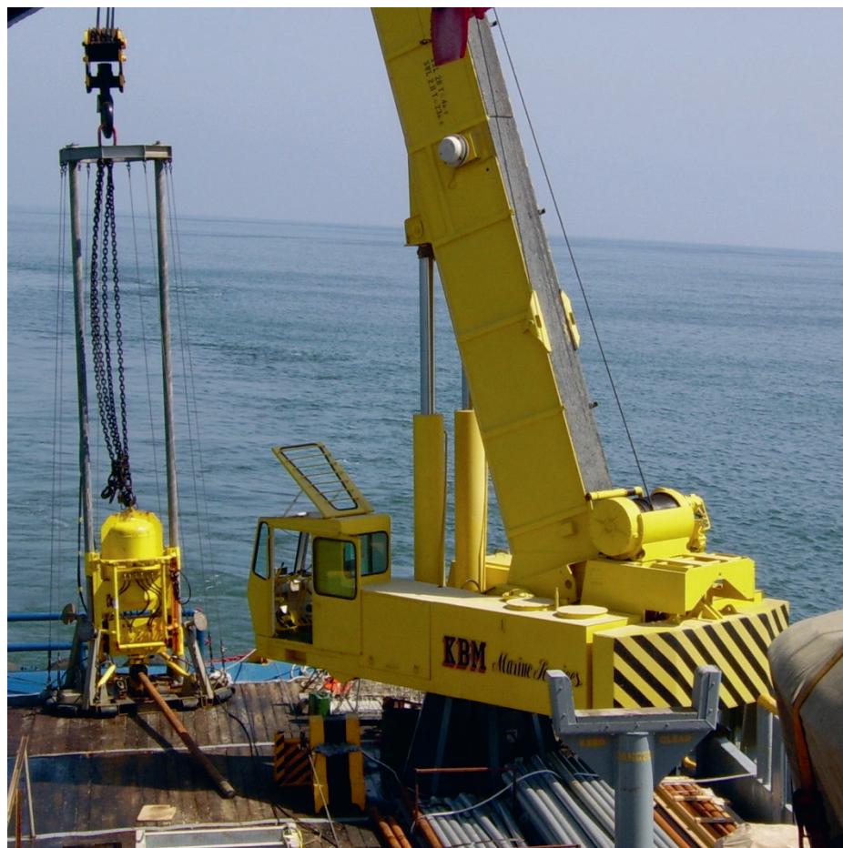
Monstername met de 'trilflip': door TNO ontwikkelde hydraulische vibrocorer.
