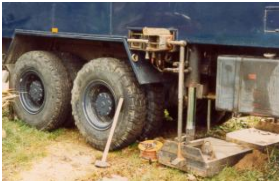
Figuur 25 – Links: Boorwagen met SCPT met seismische bron. Rechts: schets van boorwagen met seismisch conus in de grond.
