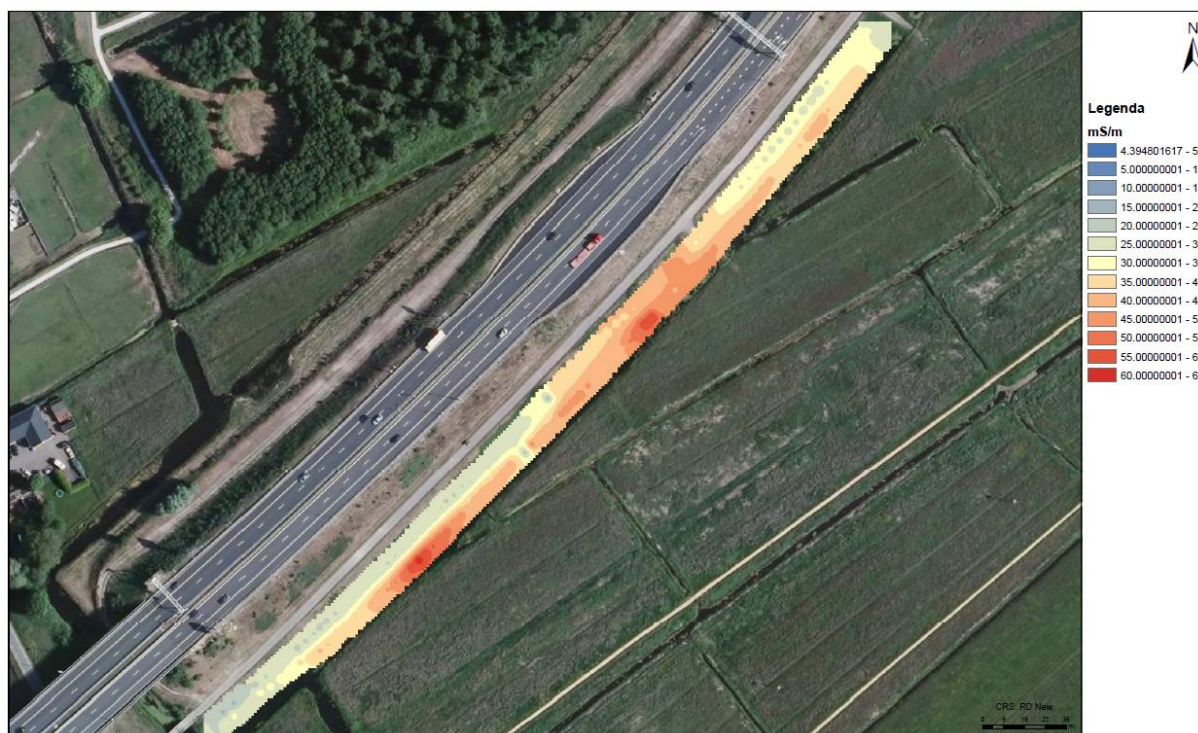
Figuur 7: Voorbeeld van ruwe EM data tussen 4,2m en 6,7 m-mv op proefvak Flankenonderzoek langs de A9
