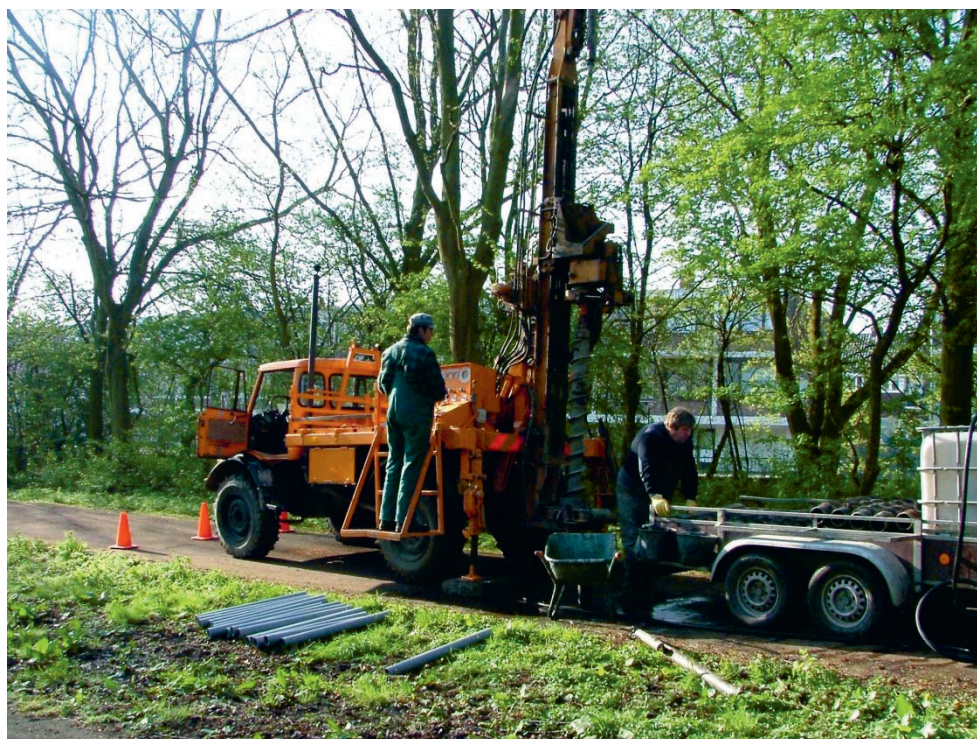
Geotechnisch onderzoek in polder Zestienhoven (kwel-locatie).
