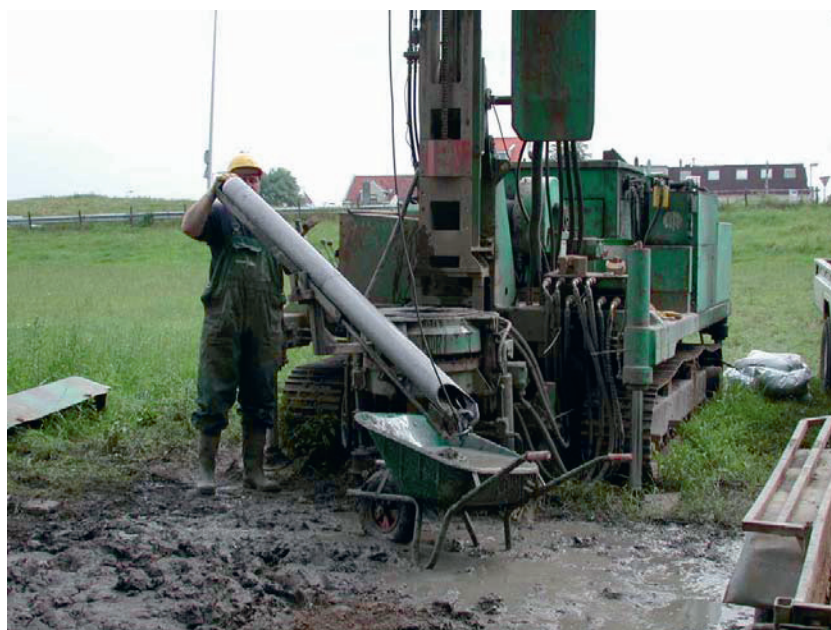
Onderzoek stabiliteit van de Bovendijk in IJsselmonde door het nemen van ongeroerde grondmonsters.
